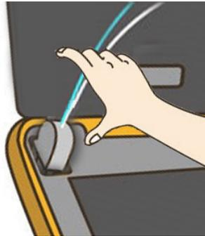
3. Setzen Sie neue Elektrodenpads in das Gerät ein. Weitere Informationen finden Sie unter *3.2.3 Anschließen der Elektroden-Pads*.
